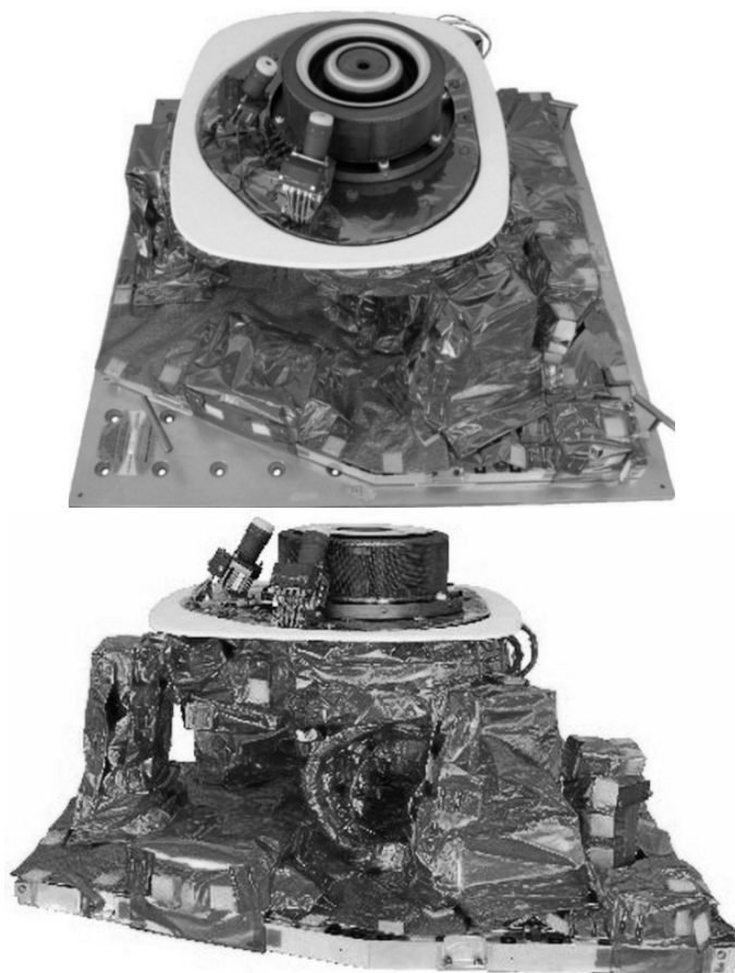
Рис. 11. Общий вид двигательного блока ITU140 на поворотном устройстве
