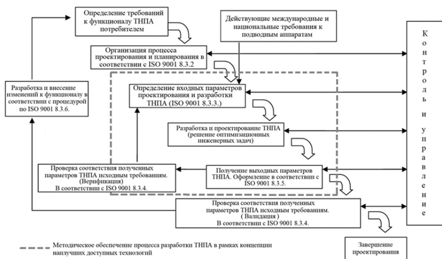
Рис. 1. Организация процесса проектирования ТНПА (на основе положений ISO 9001:2015)
